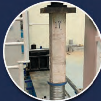
اختبار عمود خرسانة مسلحة
