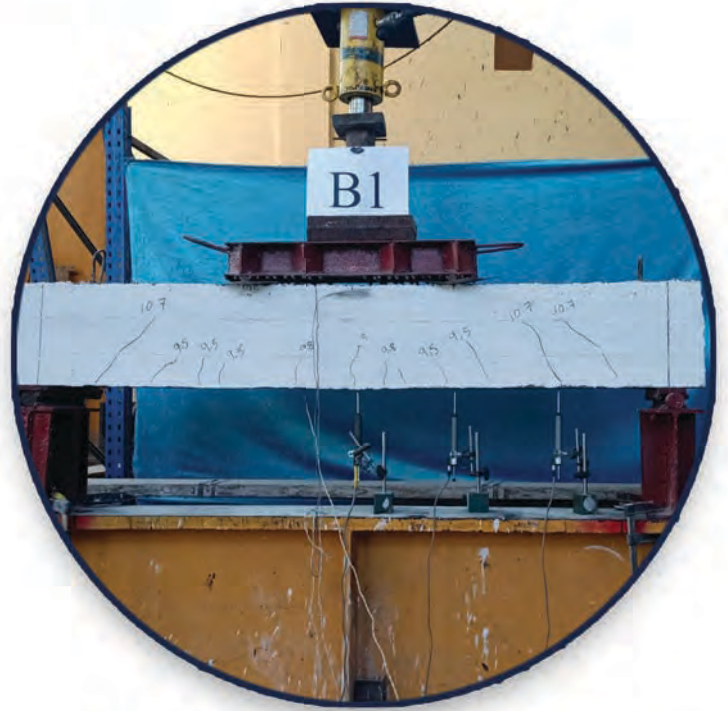
اختبار تحميل كمره خرسانة مسلحة
