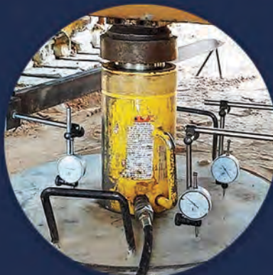
اختبار التحميل اللوحي
