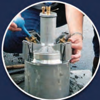
اختبار تحديد كمية الهواء في الخرسانة
