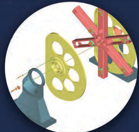
تصنيع ترس تربينه مروحة لتوليد الطاقة من الرياح
